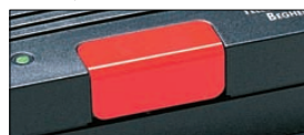
Premendo il tasto rosso si lancia un allarme a sintesi vocale a 8 numeri telefonici memorizzati oppure, in opzione a canone, al Centro SOS Beghelli.
